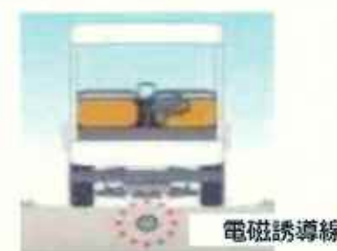
▲電磁誘導線による自車位置特定による運行の補助
